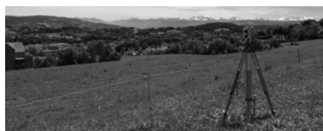
Rutschgebiet Leimbach: Totalstation. (Bild: GeoZ)
