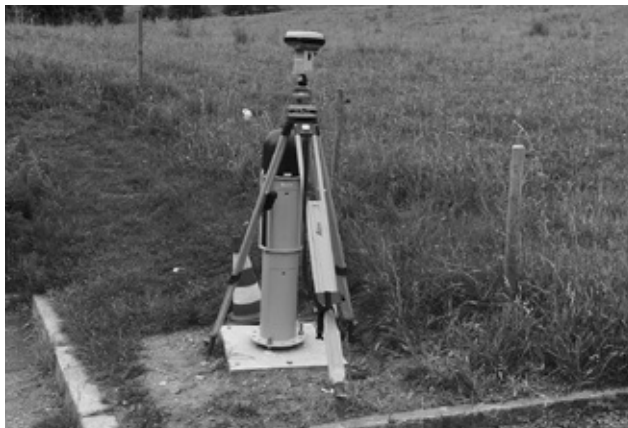
Eingerichtete Permanentstation (während Einmessung mit GPS) am Hangrutschgebiet Mittlelbach. (Bild: GeoZ)
